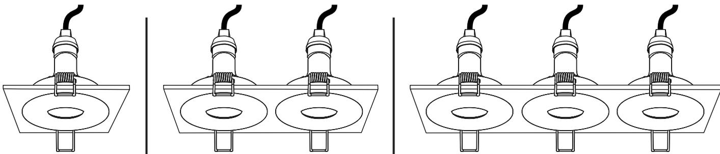
Схема монтажа с накладными рамками.
